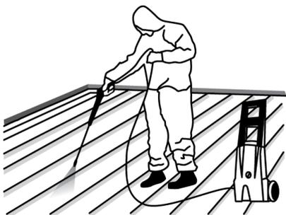
**1)** Efetuar a limpeza com hidro jato nas superfícies que serão submetidas a fim de deixá-las completamente limpas e sem contaminações e ferrugem. A superfície deve estar completamente seca, limpa, livre de pó, graxas, tintas, óleos, oxidações, restos de produtos desmoldantes.
