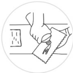
11. Para fazer o acabamento, borrife álcool em uma desempenadeira de aço, com uma angulação de  $\pm 10^\circ$ . Passe a desempenadeira na massa até ficar completamente lisa, se perceber que a desempenadeira esta com dificuldade de arraste, repita a adição de álcool na mesma (não utilizar solvente).
