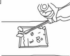
1. Raspe e remova todo o material solto e quebradiço no local a ser reparado com auxílio de ferramentas (Martelete, punção ou ferramenta apropriada). O local da aplicação não pode estar contaminado de óleo ou graxa, se tiver estes tipos de produtos no piso, estes devem ser limpos com ácidos ou detergentes.
