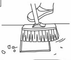
2. Para eliminar as partículas soltas da superfície, utilize uma escova de aço, elimine todas as partículas com auxílio de aspirador ou ar comprimido, a superfície a ser aplicado o Hard FR 117 deve estar totalmente limpa
