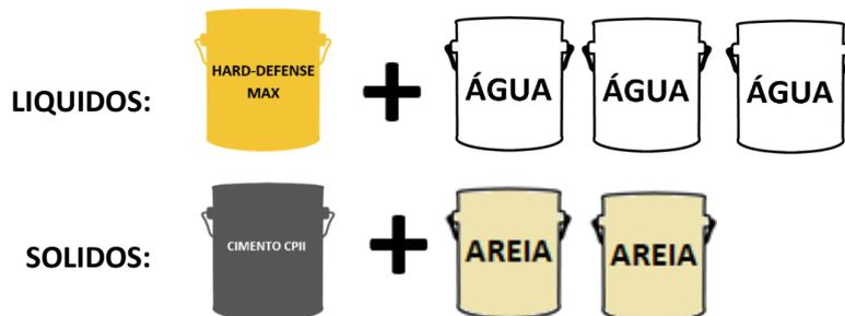
**Sugestão de aplicação:** A ponte de aderência precisa estar sempre úmida para receber o contrapiso ou microconcreto, então, se a aplicação for em uma área muito grande fazer a mistura dos produtos líquidos (HARD-DEFENSE MAX e Água) separada dos sólidos (Cimento e Areia).
