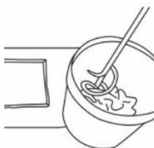
**PASSO 2:** Colocar em um recipiente limpo a proporção de produtos a serem preparados, misturar mecanicamente de 3 a 5 minutos até obter uma mistura homogênea e sem grumos.
