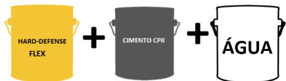
Misture este traço e aplique em uma camada sobre a superfície com rolo ou trincha. Não deixar empoçar a solução no substrato, a aplicação pode ser feita com trincha, rolo ou pincel.
