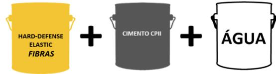
Misture este traço e aplique em uma camada sobre a superfície com rolo ou trincha. Não deixar empoçar a solução no substrato, a aplicação pode ser feita com trincha, rolo ou pincel.
