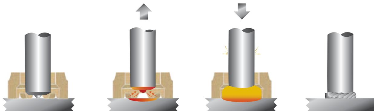
1) Encaixa-se o Stud Welding e o anel cerâmico à pistola de aplicação e pressiona-se ambos contra a superfície a ser soldada.
